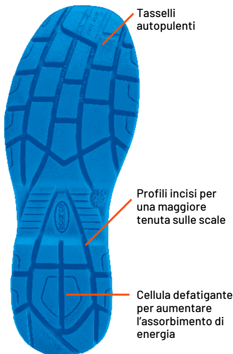
SUOLA in poliuretano bidensità, progettata per favorire un utilizzo dinamico e muoversi in sicurezza in tutte le situazioni. CONFORME SR + FO
